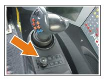
El centro de control terminal TCC es un elemento de mando para la pantalla táctil que se encuentra en el puesto de conducción. Permite manejar con comodidad dicha pantalla desde el puesto de conducción. Se trata de una alternativa paralela al manejo a través de la pantalla táctil.
