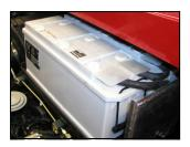
Las baterías **2 x 12 V 135 Ah/600 A** se encuentran integradas en el bastidor superior.
