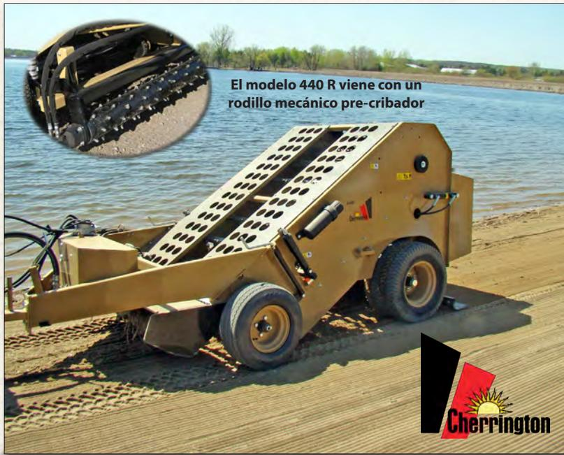
El modelo 440 R viene con un rodillo mecánico pre-cribador
