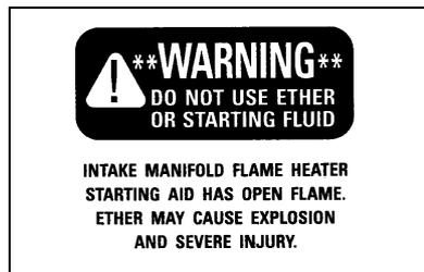
Colocado en: **motor Diesel**
