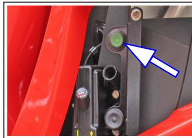
*Seccionador de la batería*
