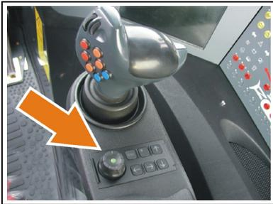
El **TCC Terminal-Control-Center** es una unidad de operación para la pantalla táctil en el salpicadero. Con el Terminal-Control-Center se puede manejar la pantalla táctil cómodamente desde el asiento. El manejo se puede realizar también paralelamente a través de la pantalla táctil.
