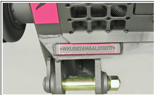
El **nº de vehículo** se encuentra impreso en la superficie frontal del lateral derecho de la parte delantera del bastidor.
