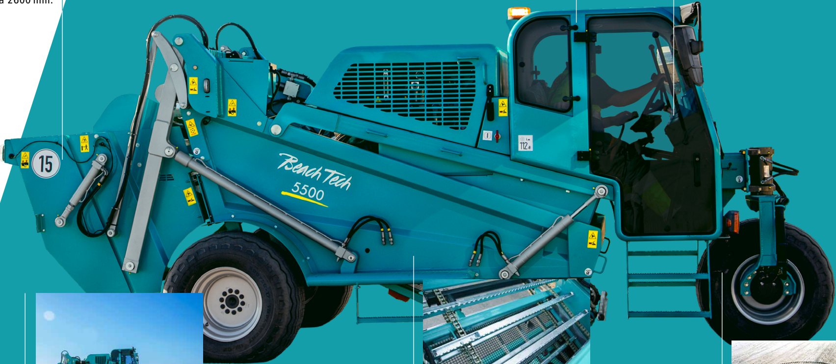
Cabina unipersonal Manejo comfortable + Joystick, panel de control y manejo digital y 2 pantallas de trabajo / sistemas de cámara de supervisión
