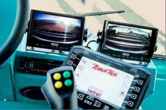
Cabina unipersonal Manejo comfortable + Joystick, panel de control y manejo digital y 2 pantallas de trabajo / sistemas de cámara de supervisión
