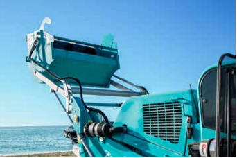
Gran recipiente colector Volumen de carga y altura de descarga + El compacto recipiente colector dispone de un volumen de carga de 1,5 m³ y de una altura de descarga flexible de 0 a 2600 mm.
