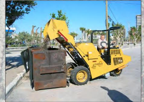
El modelo 3000 puede vaciar fácilmente la basura en los contenedores hasta 1.52 mts de altura.
